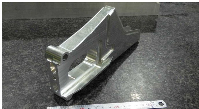
○2輪自動車部品(試作) 材質：アルミ 加工：総削り 立形マシニングセンタ・5軸加工
