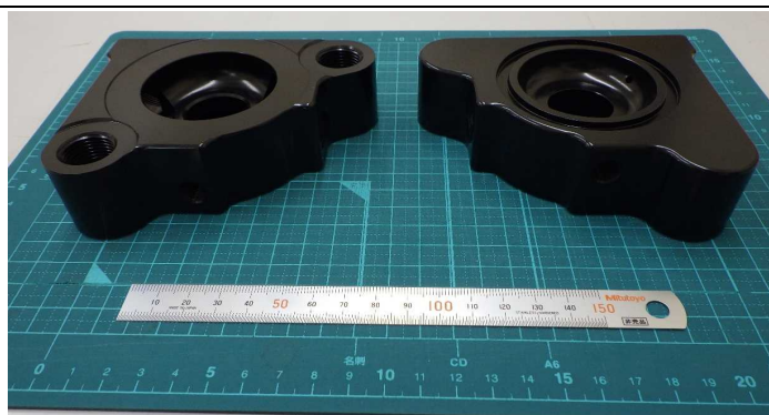
○自動車用アフターパーツ(意匠部品) 材質：アルミ 加工：総削り 立形マシニングセンタ、アルマイト処理
