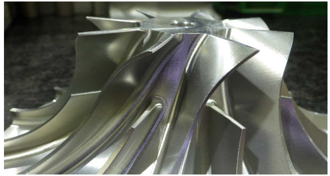
○船外機部品 材質：アルミ 加工：総削り 立形マシニングセンタ・同時5軸加工 受注数量：試作
