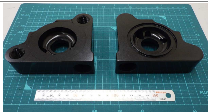
○自動車用アフターパーツ(意匠部品) 材質：アルミ 加工：総削り 自動5軸マシニングセンタ、アルマイト処理
